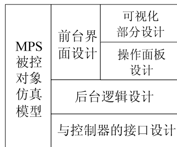
图 2 SIMIT 环境下 MPS 的仿真模型结构
