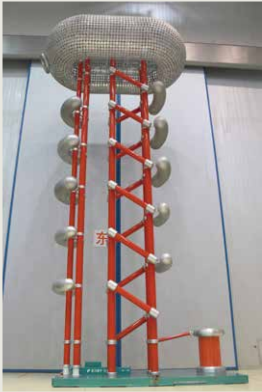
设备名称：直流电压发生器 额定电压： \pm 2400\text{kV} 额定电流： \pm 30\text{mA}
