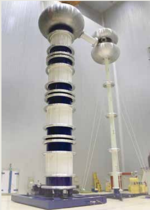
设备名称：串联谐振电压发生器 额定电压：1600kV 额定电流：10A
