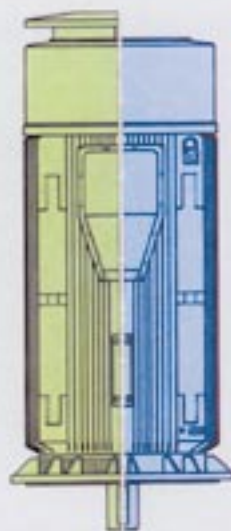
图 11: 结构形式 IM V1, 配/不配防护顶盖, 防护等级 IP 23/IP 54, 冷却方式 IC 01/IC 411
