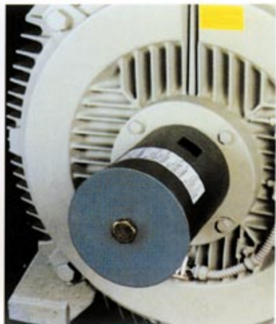
图 19: 装有滚动轴承的电机转子固定装置
