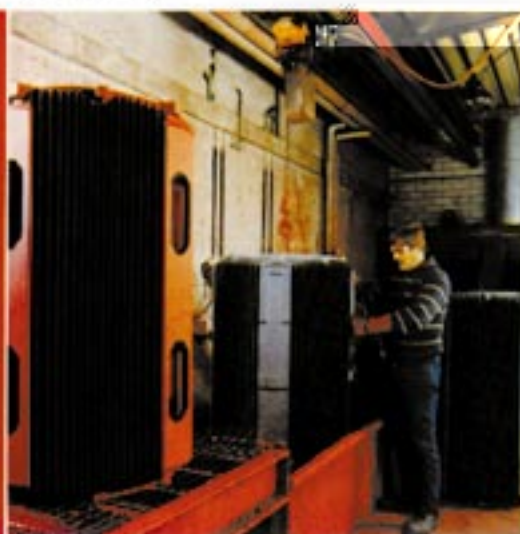
图 28: IM V1 结构形式的壳体在浸渍厂做初始涂敷处理
