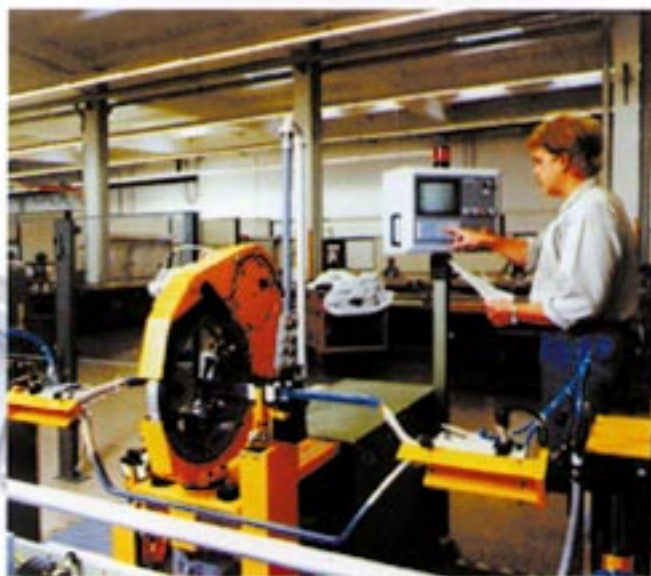
图 21: 槽部线圈的全自动绝缘
