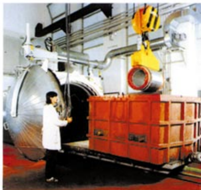
图 20: 把已完成绕组连接的定子落入浸渍箱中
