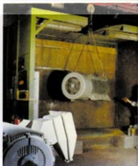
图 29: 用于第二覆盖涂层和外表面喷涂的喷雾室
