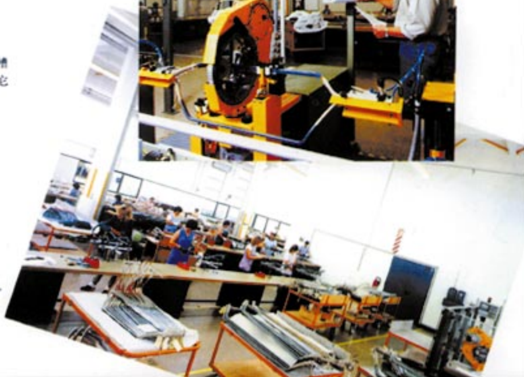
图 22: 在特殊“无尘室”中的线圈生产
