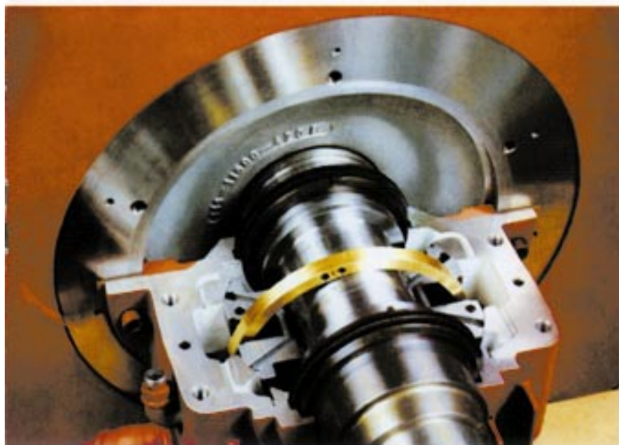
图 18: 带油环的法兰式滑动轴承
