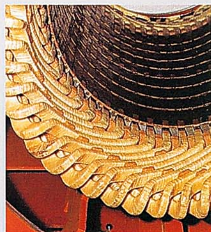
图7 采用MICALASTIC® 绝缘的定子
