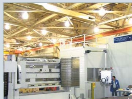
高性能加工中心 Ecospeed F 的整体外观。其中包括，床身 (右边)、工作台 (左后方)、托盘交换台 (左前方)。
