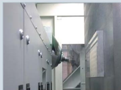
工作中的基于三臂系统的 Sprint Z3 主轴箱。
