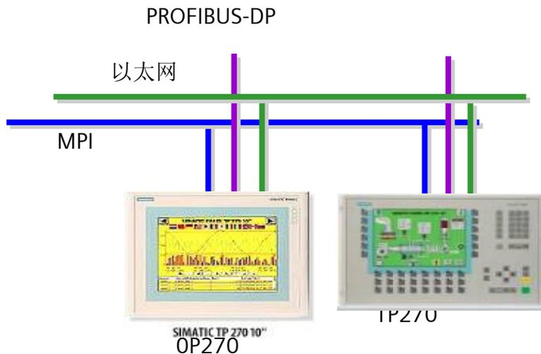
➤ **OP 270-10,,** 具有综合功能性的触摸型面板用于对机器可视化有要求的应用场合；像素式图形 10.4" STN 触摸屏 (模拟/电阻性)，彩色 (256 色)；所有接口 (例如 MPI, PROFIBUS DP, USB; Ethernet optional) 都在板上；38 个可系统功能键，其中有 36 个是自由组态和自定义说明的功能键
