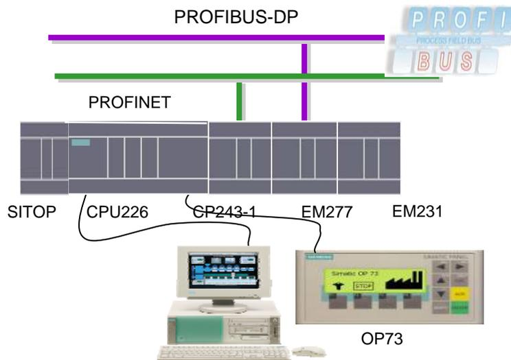
➤ **CPU226** 用于复杂技术任务的高性能软件包；带有另外的PPI端口来增加灵活性和通讯选项；板上有40个输入/输出；最多可有7个扩展模块。
