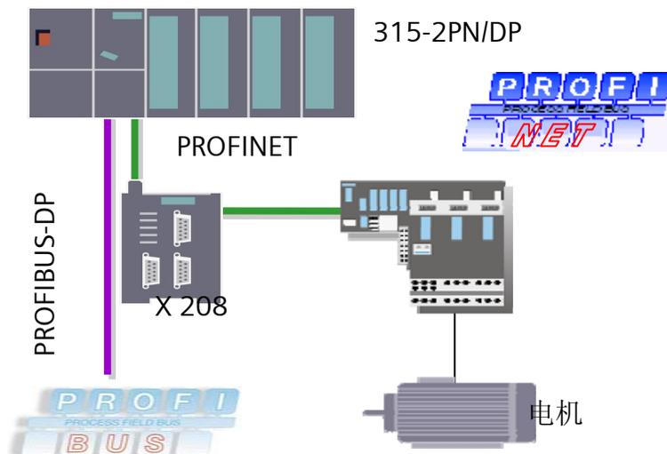
➤ **CPU315-2 PN/DP** 256 KB工作内存；1个MPI/DP接口12Mbit/s；1个工业以太网PROFINET接口；CPU运行必须带有MMC卡，高性能处理开关量和浮点运算；一般作为生产线上远程I/O的中央控制器；灵活的扩展功能；具有方便的运动控制功能，带有闭环控制功能块及PID控制模块。
