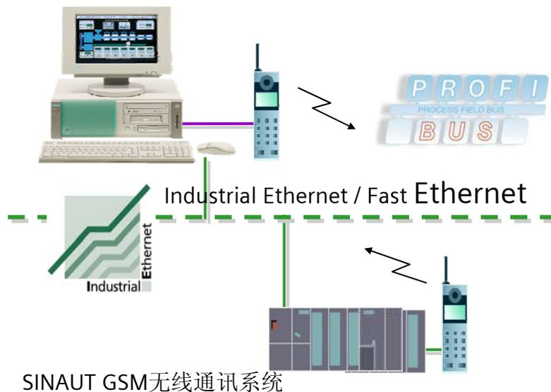
➤**MC45 GSM** MC45 GSM 套件用于通过移动电话网络（GSM）进行数据传输；可连接到具有相应部件的 TIM（TIM 3V 和所有 TIM 4 模板）模板的串行调制解调器接口。
