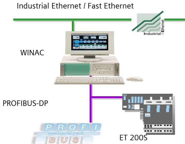
➤ **WINAC STATION** 适用于具有苛刻和严格实时要求的任务。它直接以Windows为基础，其增强的实时性能保证对控制部分具有确定性响应；WinAC RTX为了改善控制质量，提供了具有新的功能强大特征的等时线模式。等时线模式提供了恒定的可重复响应时间，因此，举例来说，WinAC RTX特别适用于利用PROFIBUS的高速闭环控制任务。
