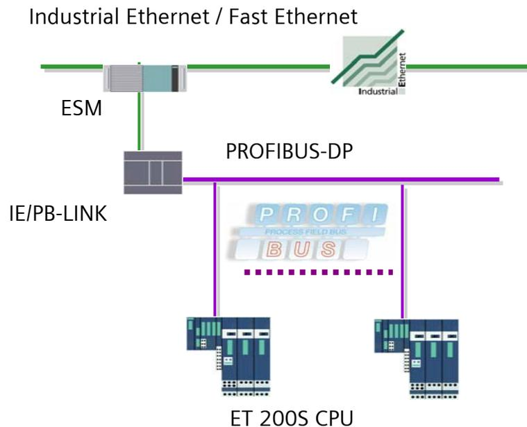
➤ **ET200S CPU** 带有集成CPU的接口模块，用于SIMATIC ET 200S分布式系统；通过 PROFIBUS DP 编程，采用了新型的 SIMATIC 微型存储器卡 (MMC) ；
