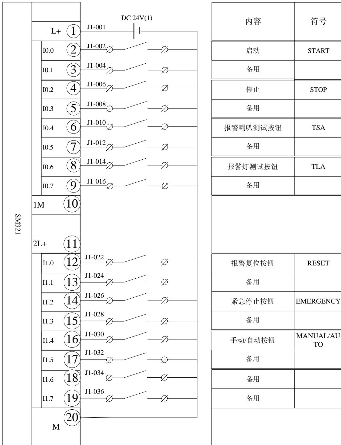
附图 4 开关量输入接线图
