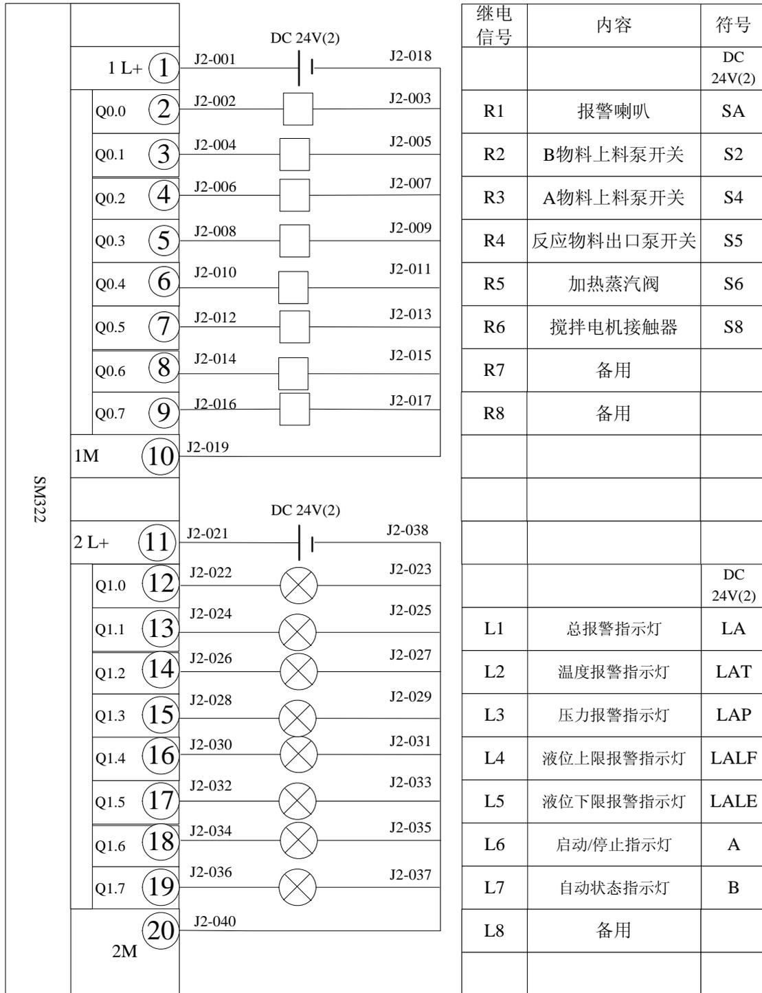
附图 5 开关量输出接线图
