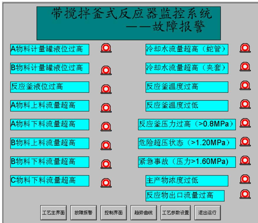
图 5.2 带搅拌釜式间歇反应器故障报警界面
