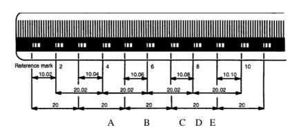
例如从 A 点移动到 C,中间经过 B 点,系统检测到 10.02 就知道轴现在在是哪一个参考点位置,同样从 B 点移动到 D,中间经过 C 点,系统从 C 点到 D 点的距离是 10.04 就知道轴现在在是哪一个参考点位置,所以只要轴任意移动超过两个参考点距离 (20mm)就能得到机床的绝对位置。
