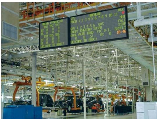
图 2: BBDC 总装生产线上使用的动态看板，ANDON 实时显示生产信息
