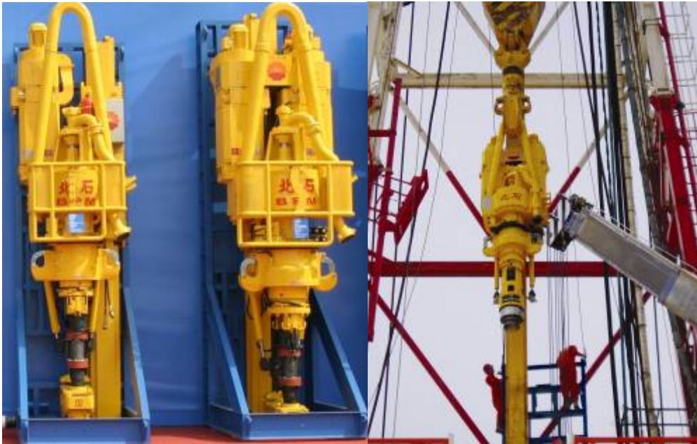
图 4：交流变频顶部驱动钻井装置图片及其应用于石油钻采现场
