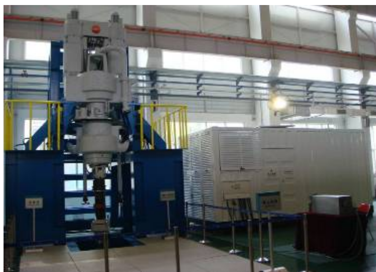
图 5: 交流变频顶部驱动钻井装置生产车间
