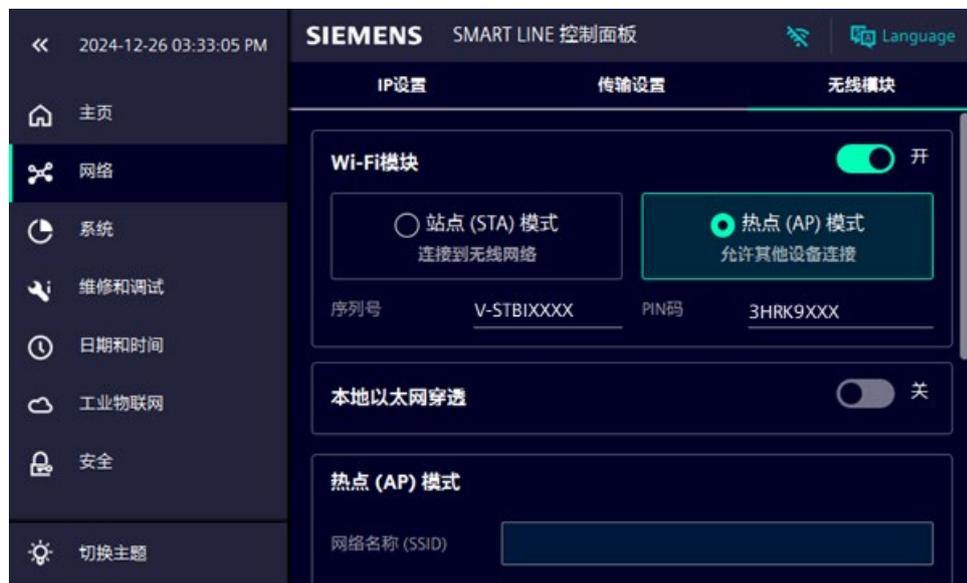
启用“本地以太网穿透”(Local Ethernet Transmission) 后，可以组态通过以太网远程控制连接到面板的 PLC 或 HMI 设备。下图所示为远程维护应用：
