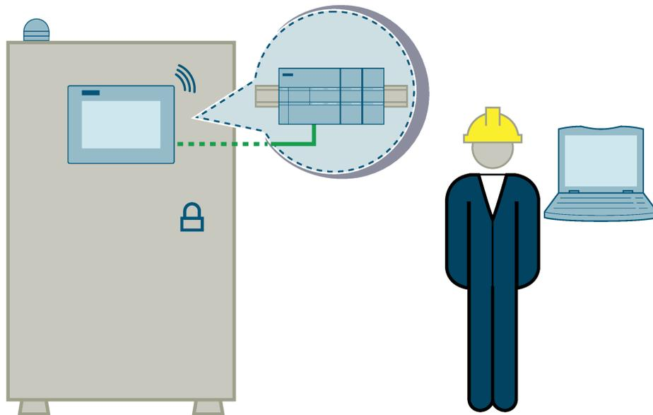
本实际使用示例说明如何在使用 Wi-Fi 模块的 Smart IE V5 HMI 中通过本地以太网穿透功能访问 SIMATIC S7-200 SMART PLC。
