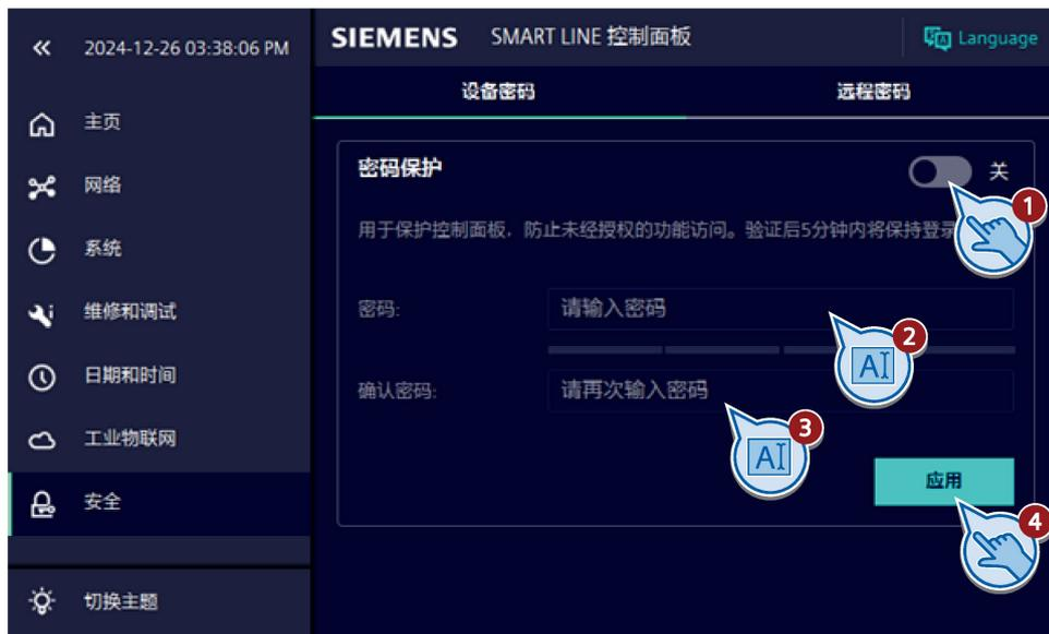
如果要取消设备密码保护，则禁用“密码保护”(Password Protection)，然后按“应用”(Apply) 按钮。
