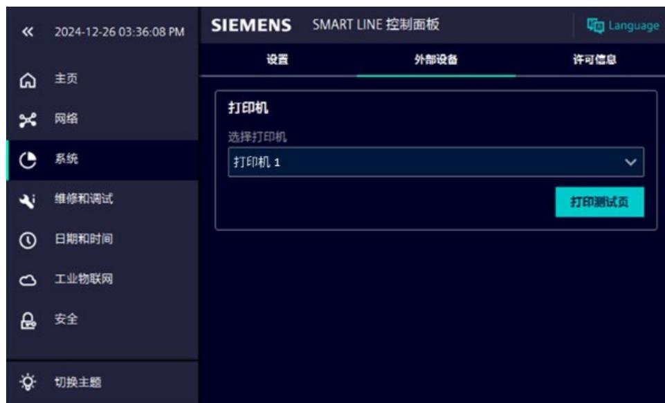
可以在此处打印所连打印机的测试页。
