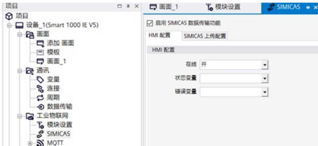
4. 在“SIMICAS 上传配置”(SIMICAS Upload Configuration) 窗口中的变量表中，添加项目的所有变量。
